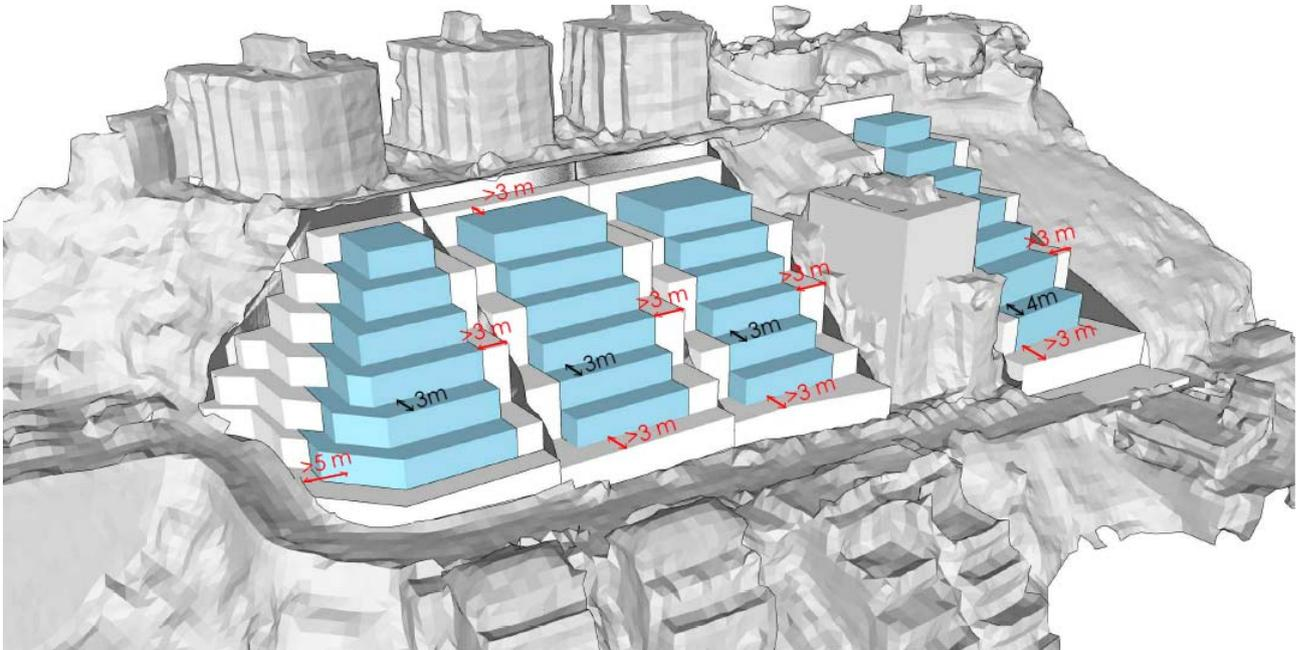
Esquema de volumetría según las secciones tipo del Estudio de Detalle
