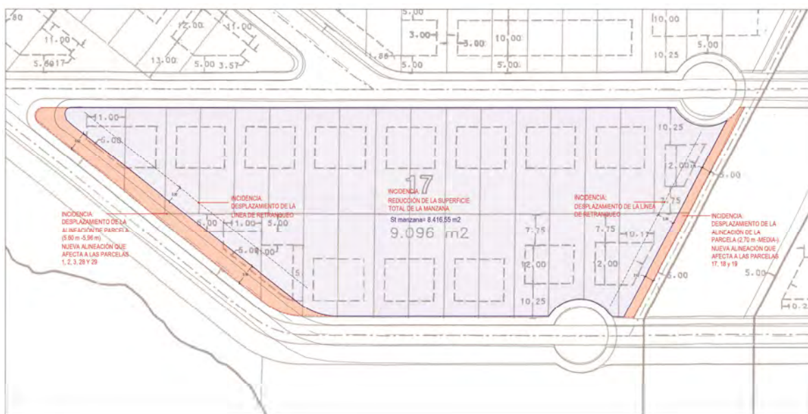
Superposición Plan Parcial-Levantamiento topográfico
