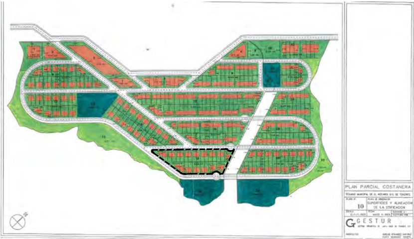
PLANO DE SUPERFICIES Y ALINEACIÓN DE LA EDIFICACIÓN DEL PLAN PARCIAL
